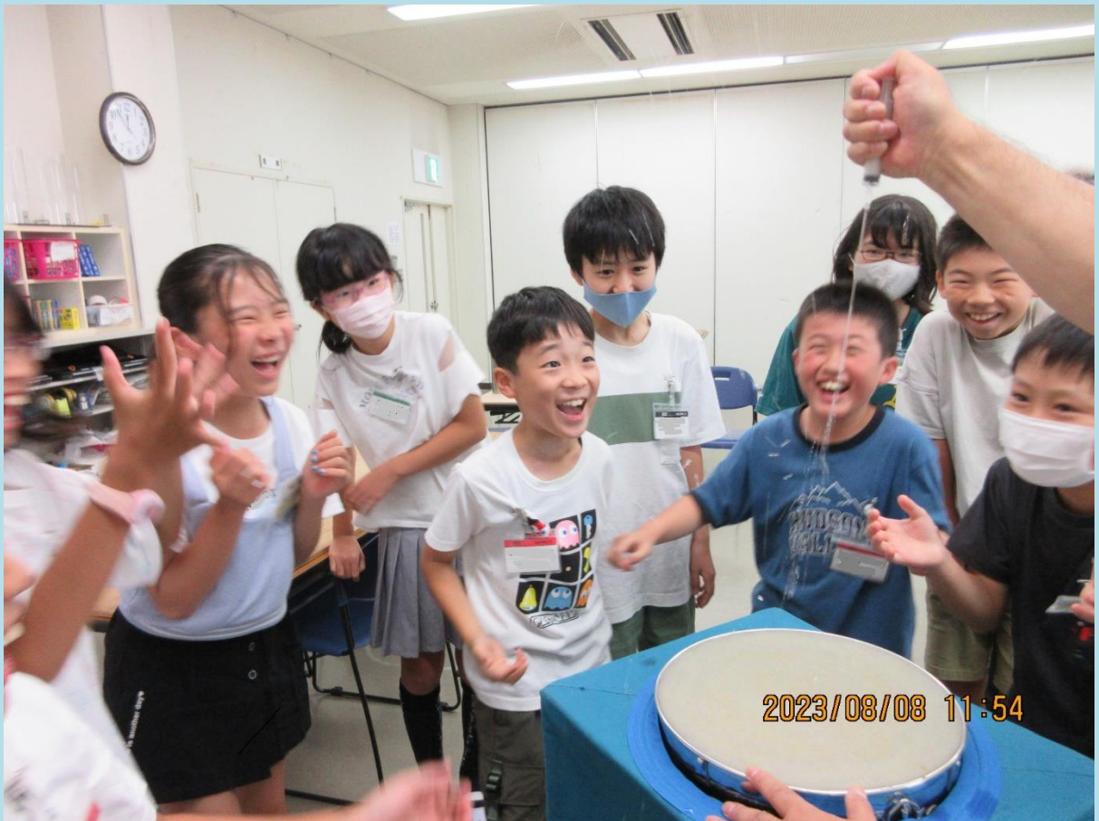
雨粒を空中で止めて粒の形状を観察する実験
